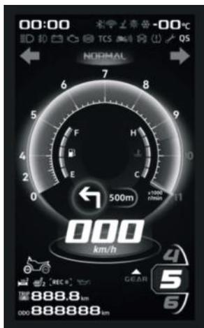
Cuando el tablero está encendido: en el inicio, el tablero mostrará la configuración del último uso. Luz de fondo del tablero: el tablero cambia automáticamente el brillo del fondo según la intensidad de la luz.
