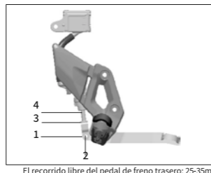
El recorrido libre del pedal de freno trasero: 25-35mm
