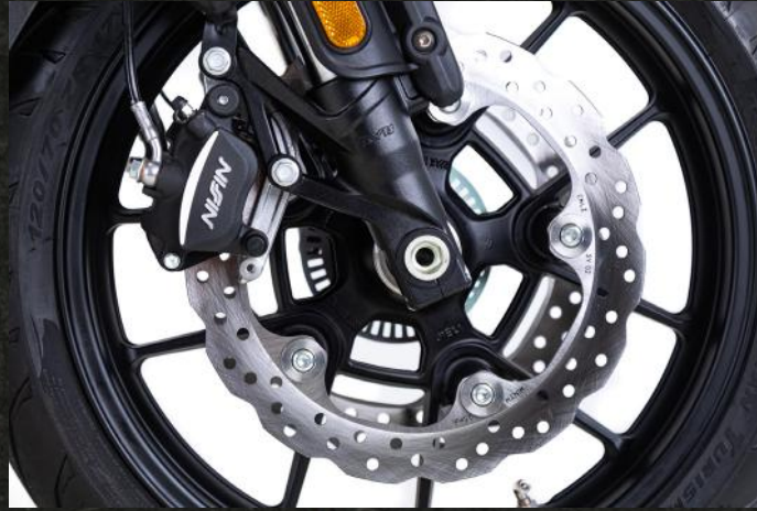
Freno delantero Nissin. Doble disco. ABS
